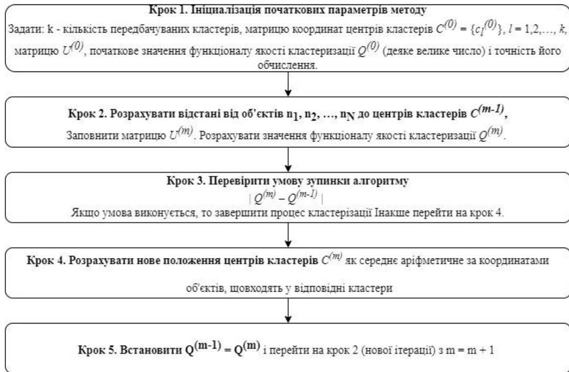
Рис. 1. Схема алгоритму кластеризації за методом k-середніх
