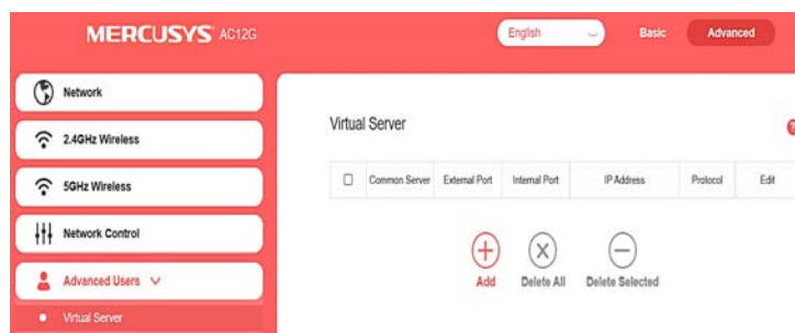
Рис. 7. Переадресація (PAT) у роутері Mercusys AC12g
