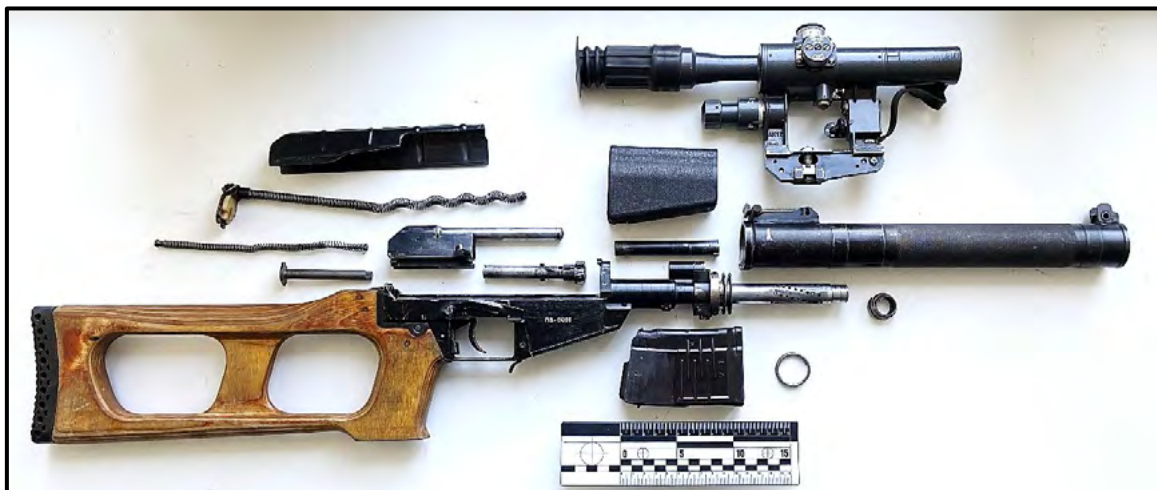
Ілюстрація № 1. 9,0-мм гвинтівка снайперська спеціальна та її основні частини
