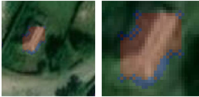
Рис. 4. Ортогоналізація сегмента. Ключові вершини обведені синім кольором
