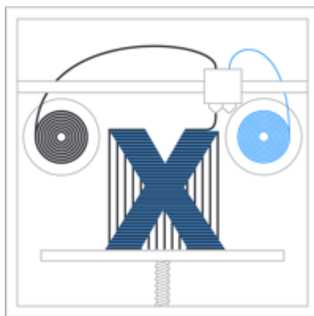
Рис.1.15 – Приклад CFR технології друку
