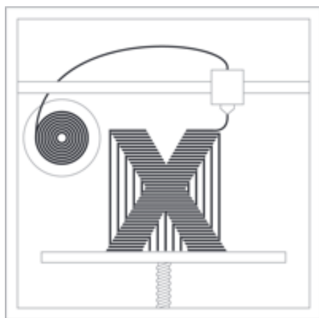
Рис.1.14 – приклад FFF технології друку
