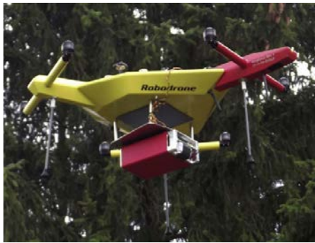
Рис. 5. Міні-бортовий гамма-спектрометричний прилад у польоті [30]
