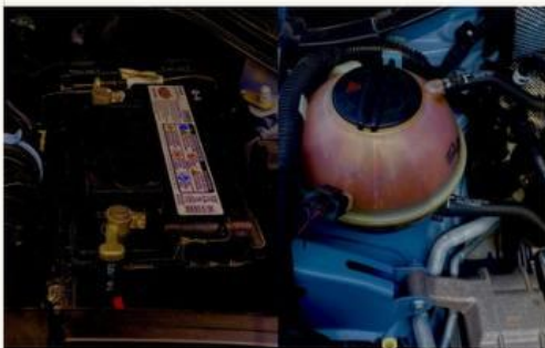
На фото – розширювальний бачок у Volkswagen. Авторка фото- Литовка Руслана
