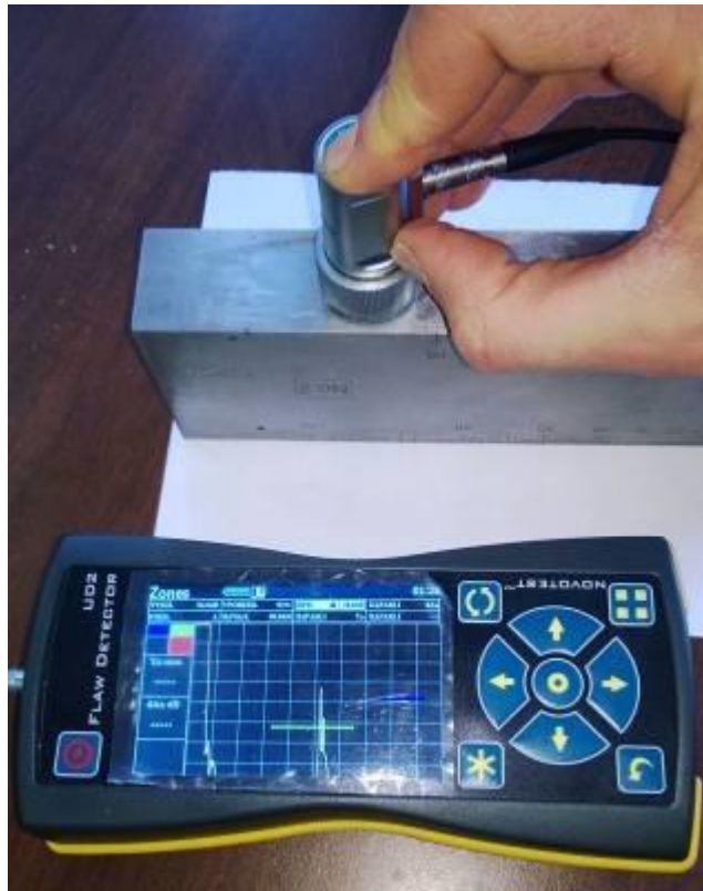
Рис. 3.3 Застосування портативного дефектоскопа для перевірки зварних з'єднань
