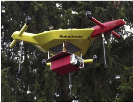
Рис. 5. Міні-бортовий гамма-спектрометричний прилад у польоті [30]
